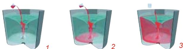
Настоятельно рекомендуется устанавливать мешалку в емкости эксцентрично по отношению к оси емкости, для того, чтобы свести к минимуму риск возникновения сильной вихревой воронки и, чтобы избежать установки отражательных перегородок.
